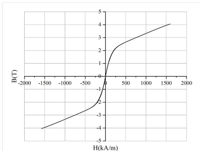
Fig 4: 磁感应强度与磁场强度关系
